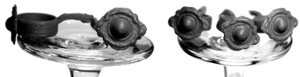
Rys. 7. Modele uzyskane przez wtrysk wosku do gumowej matrycy
