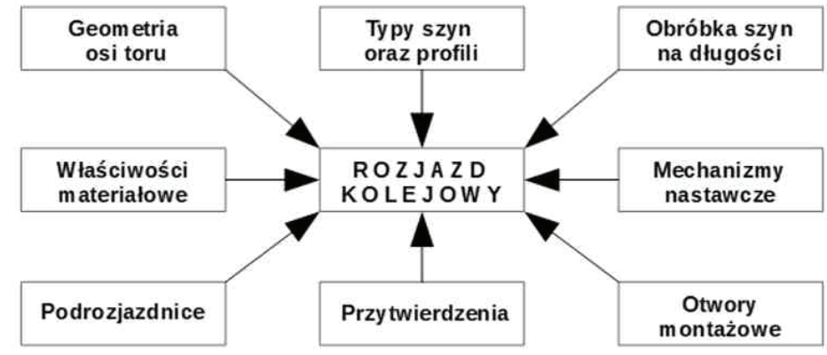
Rys. 1. Grupy parametrów modelu konstrukcyjnego rozjazdu
