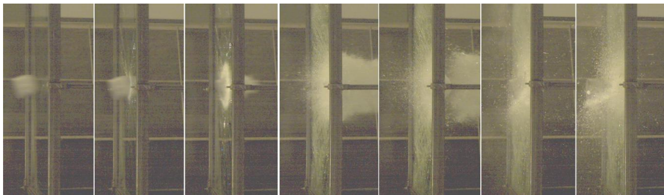
Rys. 10. Test próbki szyby nagrany szybka kamerą – pocisk nie przebija szyby
