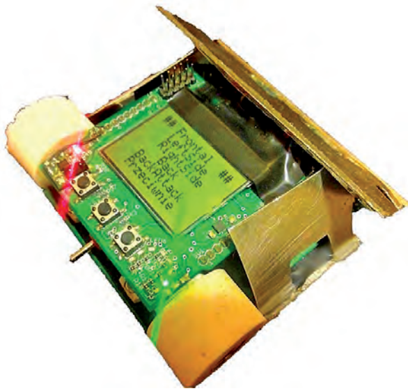
Rys. 3. Interfejs graficzny pozwalający na wybór strategii walki Fig. 3. Graphical interface used to choose a strategy for a fight
