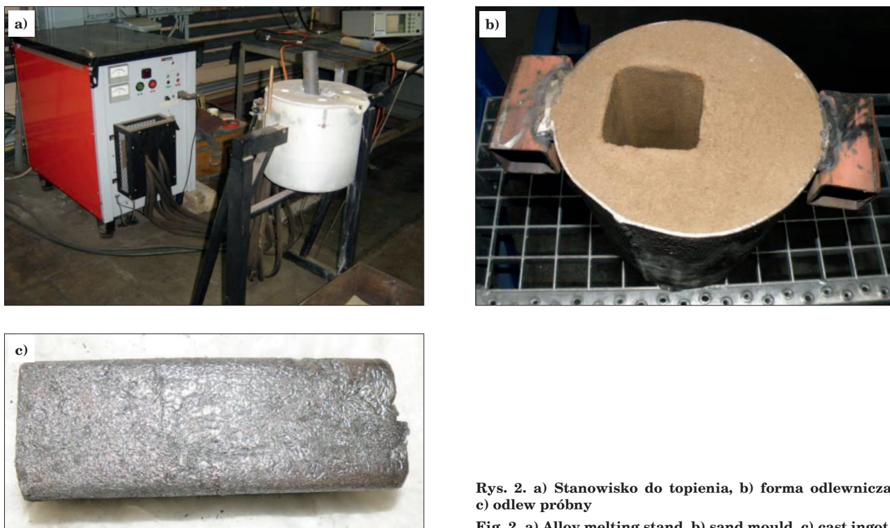
Fig. 2. a) Alloy melting stand, b) sand mould, c) cast ingot
