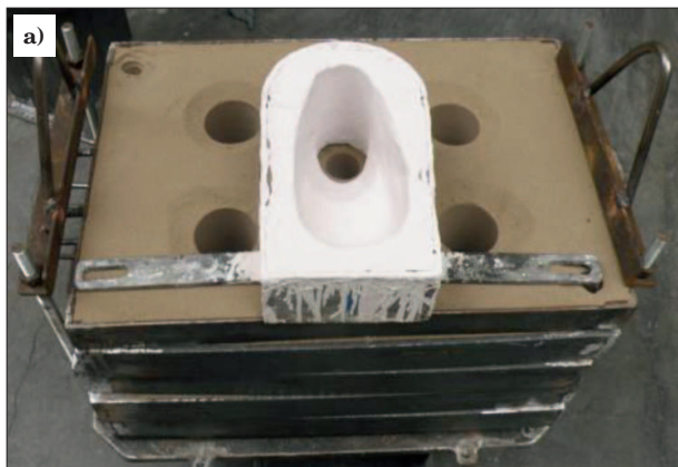
Rys. 6. Forma odlewnicza piaskowa (a) oraz odlewy płyt (b) Fig. 6. Sand mould (a), plate casts (b)
