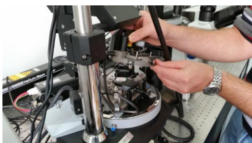
Rys. 1. Umieszczanie próbki w głowicy mikroskopu sił atomowych NT-MDT Ntegra Spectra C.
