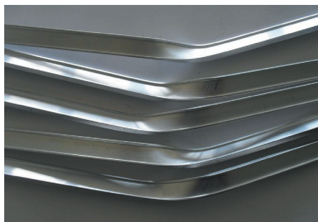
Rys. 5. Deformacje profili dwuteowych o wymiarach poprzecznych 18x5.7x2x1.6
