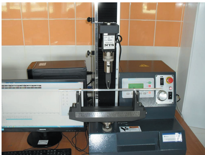
Rys. 3. Stanowisko badawcze, na którym wykonano testy gięcia profili
