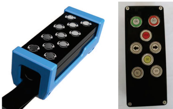
Rys. 7. Pilot bezprzewodowego systemu sterowania BLUESTER [3]
