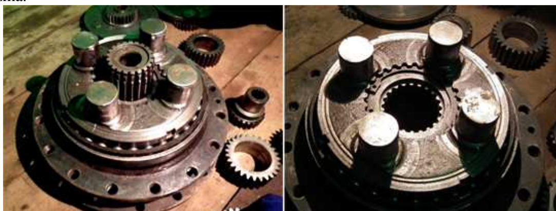
Fot. 2. Uszkodzenia tarczy jarzma satelitów trzeciego szeregu planetarnego
