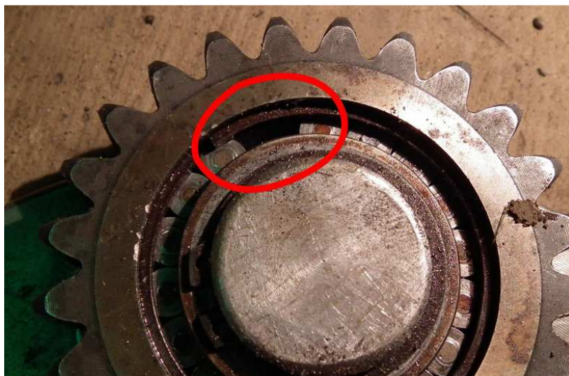
Fot. 11. Łożysko satelity drugiego szeregu planetarnego – brak jednej rolki
