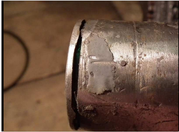
Fot. 8. Zwężenia rowka pod pierścień osadczy
