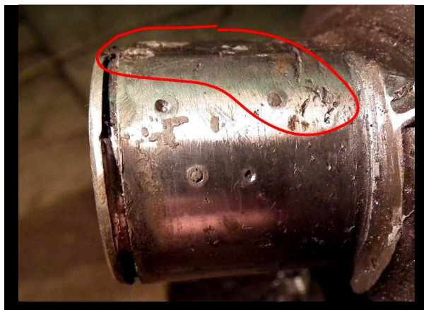
Fot. 3. Ubytki materiału czopa
