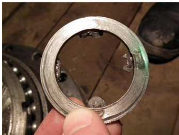
Fot. 13. Podkładka spawana do czopa
