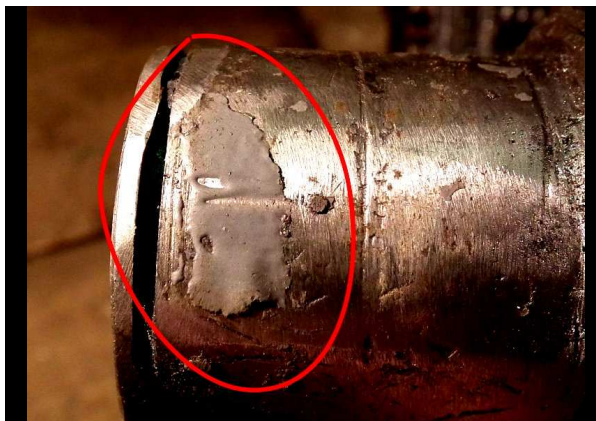
Fot. 6. Substancja obca na powierzchni bocznej czopa
