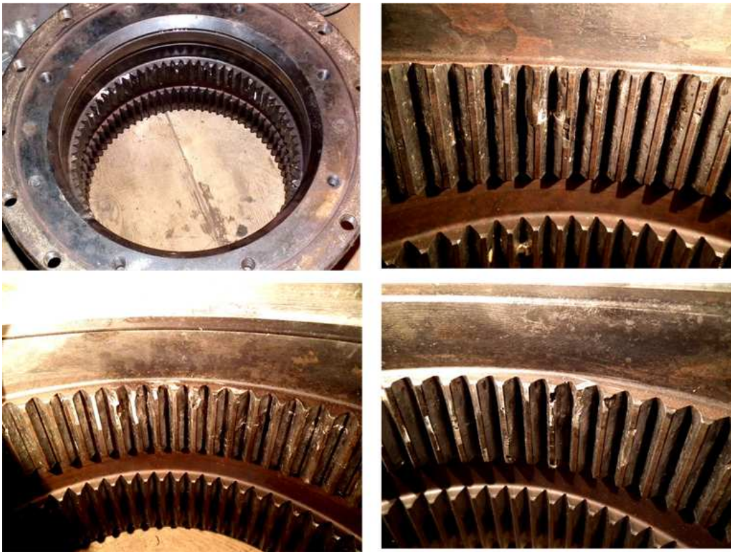
Fot. 10. Uszkodzenia wieńca zębatego w obudowie ZWOLNICY
