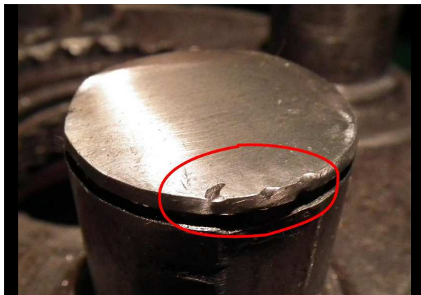
Fot. 5. Ślad zeszlifowanej spoiny spawalniczej
