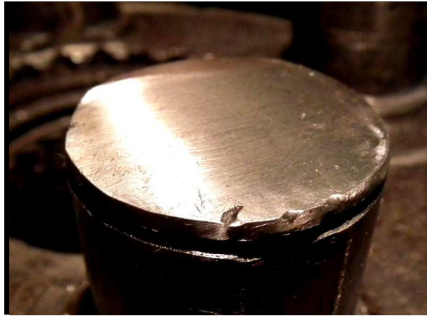
Fot. 7. Zeszlifowana powierzchnia czołowa czopa
