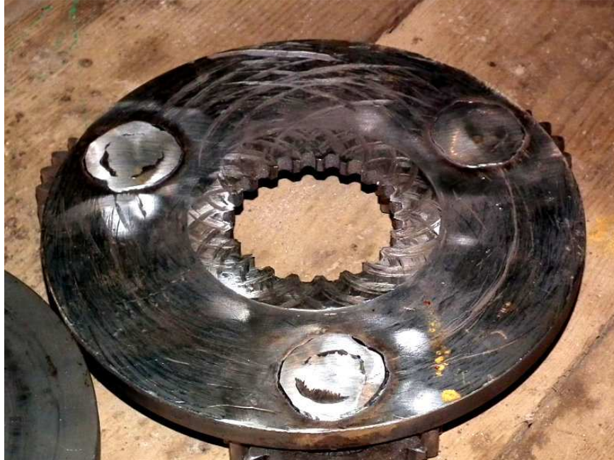
Fot. 12. Porysowana powierzchnia tarczy jarzma satelitów drugiego szeregu planetarnego
