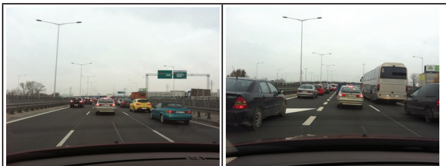
Równomierne kolejki pojazdów na trzech pasach w odległości ok. 500-400 m od przewężenia
