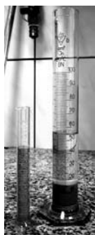
RYSUNEK 6. Badanie swobodnego pęcznienia FIGURE 6. Free swelling test
