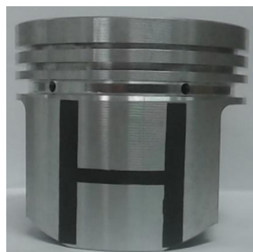
Rys. 1. Tłok z naniesioną warstwą grafitu na powierzchni nośnej w kształcie litery H
