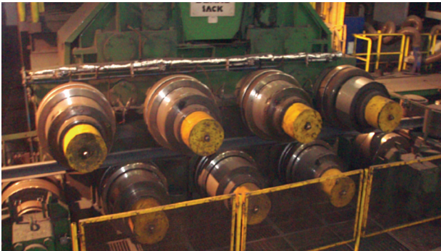
Rys. 2. Prostowanie szyn w prostownicy dziewięciorolkowej [fot. autorów]
