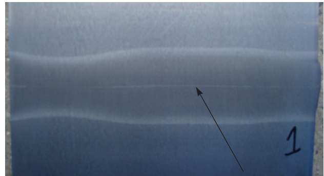
Rys. 5. Linia zgrzewania szyn na przekroju wzdłużnym [fot. autorów]
