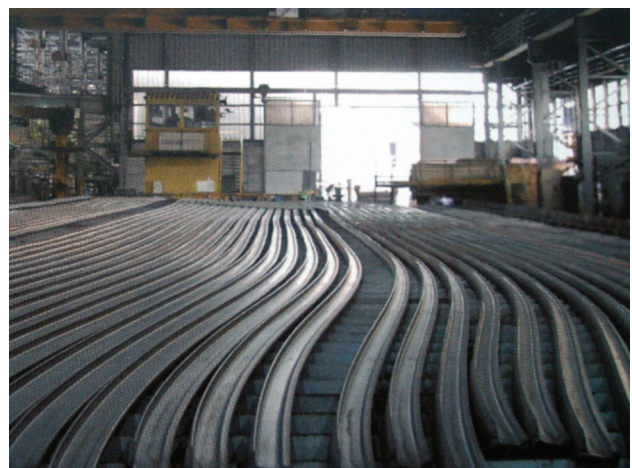
Rys. 1. Chłodzenie szyn po walcowaniu na rusztach chłodni [fot. autorów]
