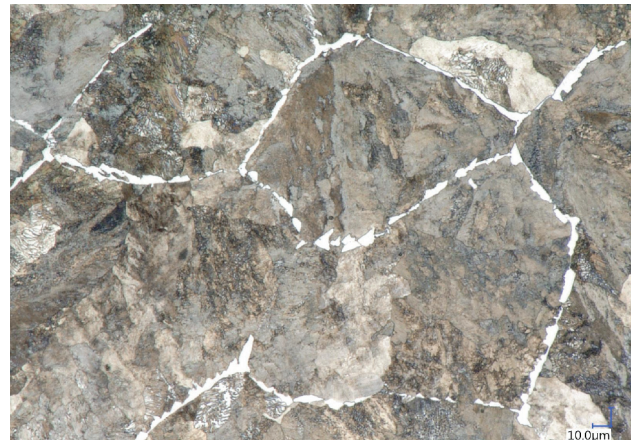
Rys. 15. Linia zgrzewania złącza szynowego z gatunku R260 po badaniach zmęczeniowych [fot. autorów]
