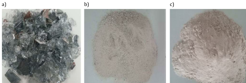
Rys. 1. Rozdrobniona stłuczka szklana kineskopowa: a) wstępnie rozdrobniona; b) zmielona w młynie (B); c) zmielona w młynie i dwukrotnie przemielona w dezintegratorze (A)
