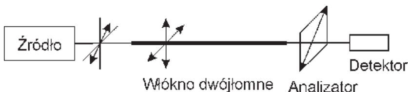
Rys. 4. Schemat stanowiska pomiarowego w metodzie polarymetrycznej
