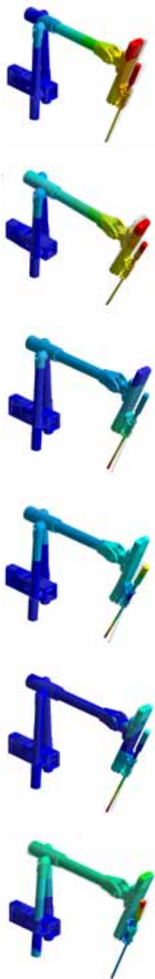
Rys. 19. Wyniki analiz częstości i postaci drgań własnych dla położenia podstawowego: od góry: f_1=10\text{Hz} , f_1=13\text{Hz} , f_1=29\text{Hz} , f_1=39\text{Hz} , f_1=42\text{Hz} , f_1=63\text{Hz} .
