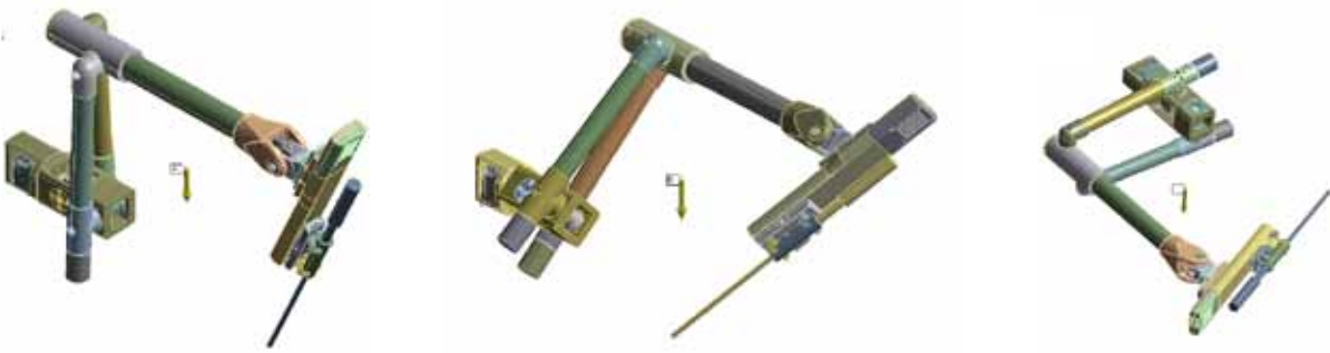
Rys. 14. Wizualizacja przykładowych obciążeń przyjętych do badań symulacyjnych ugięcia pod ciężarem własnym: od lewej: położenie podstawowe, obrót na pierwszym stopniu swobody o kąt 45°, obrót na pierwszym stopniu swobody o kąt 90°.
