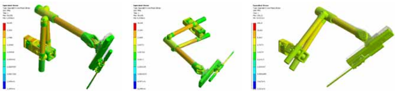
Rys. 16. Przykładowe rozkłady naprężeń zredukowanych dla różnych położeń manipulatora pod obciążenia ciężarem własnym.
