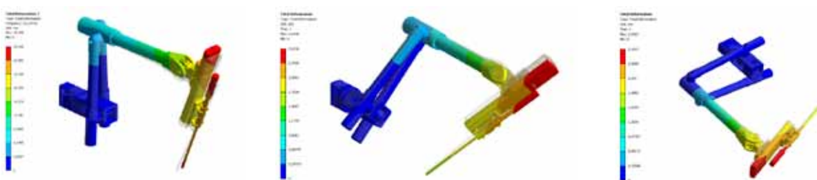
Rys. 17. Przykładowe rozkłady przemieszczeń wypadkowych dla różnych położeń manipulatora pod obciążenia ciężarem własnym.
