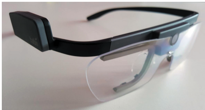
Fot. 1. Mobilna aparatura eyetrackingowa (Tobii Pro Glasses 2) (fot. P. Szymański)
