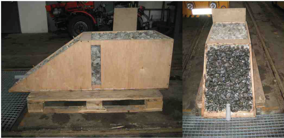
Fot. 1. Badanie wodoprzepuszczalności tłucznia pokrytego żywicą
