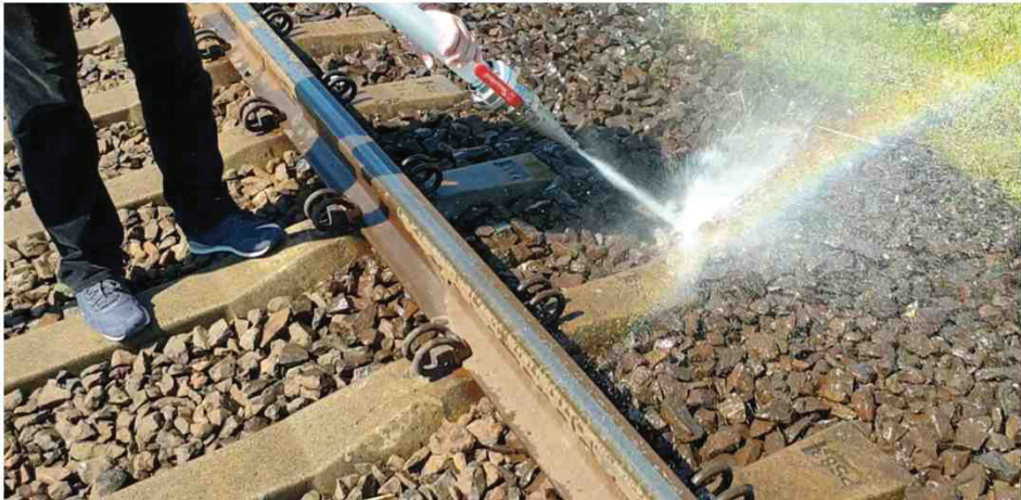
Fot. 2. Badanie rozmywania tłucznia
