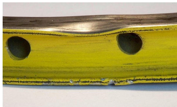
Rys. 12. Przykład uszkodzonej obręczy koła osłabionej przez tarcie zużytego klocka hamulcowego
