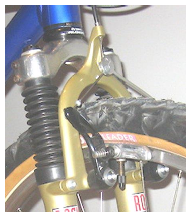
Rys. 4. Mocowanie hamulca typu Cantilever na widelcu amortyzowanym
