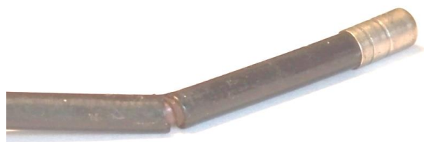
Rys. 19. Przerwany jeden z drutów linki hamulcowej
