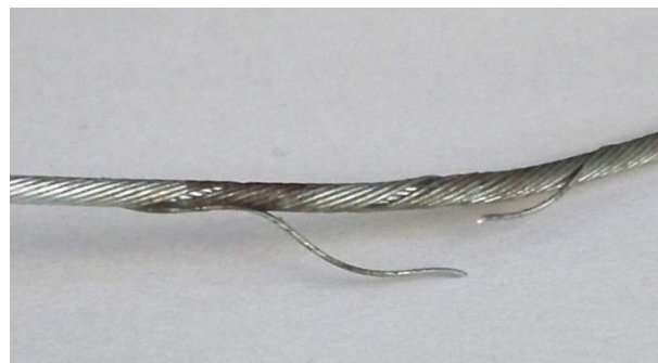
Rys. 18. Przerwany jeden z drutów linki hamulcowej
