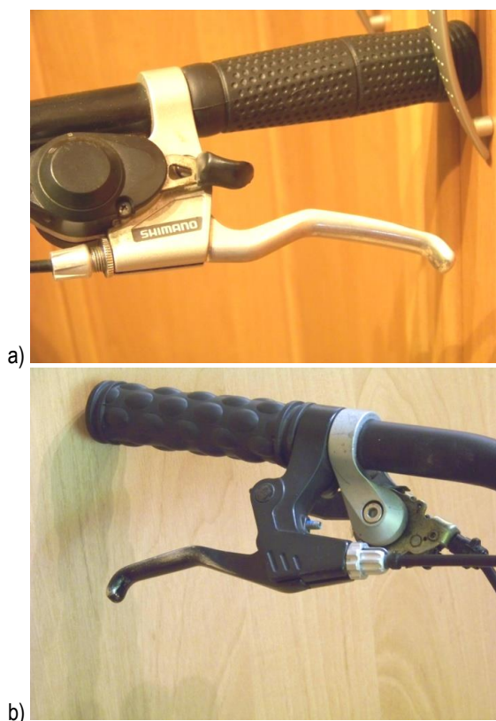
Rys. 5. Porównanie długości klamek hamulcowych stosowanych w hamulcach typu Cantilever (a) oraz V-brake (b)
