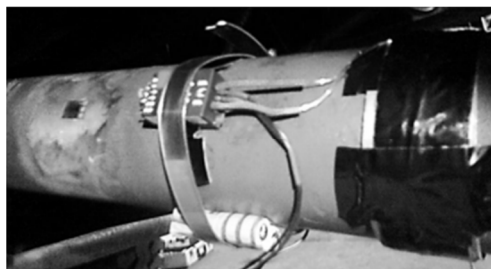
Rys. 5. Układ pomiarowy w trakcie montażu na wale napędowym obiektu badań Fig. 5. The measuring system during assembly on the drive shaft testing facility
