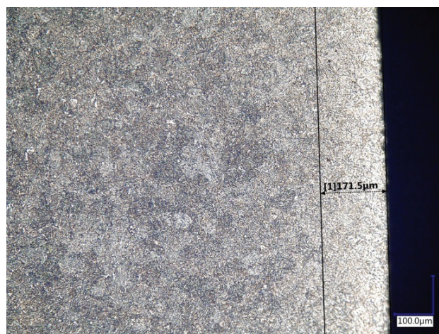
Rys. 2. Pomiar odwęglenia w stali 48Si7 [fot. M. Ostromecka]
