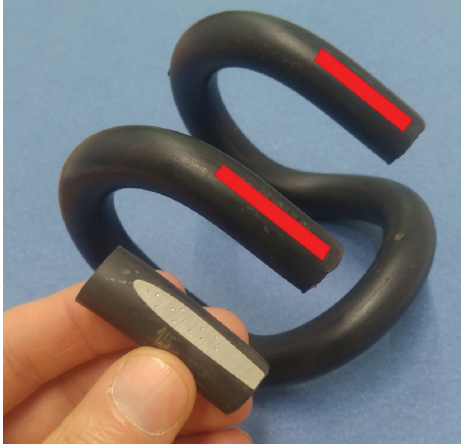
Rys. 3. Łapka sprężysta SB4 z zaznaczonym na czerwono miejscem pomiaru twardości oraz przygotowana próbka z odciskami po wykonanych pomiarach twardości [fot. A. Aniszewicz]
