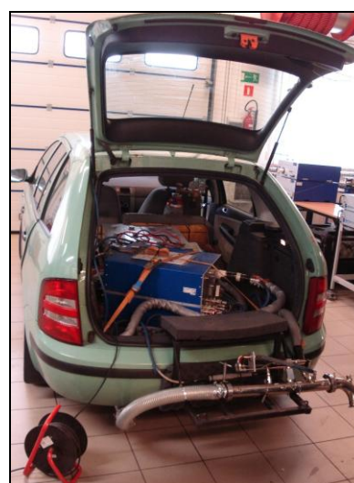
Rys. 4. Aparatura pomiarowa typu PEMS zamontowana w pojeździe
