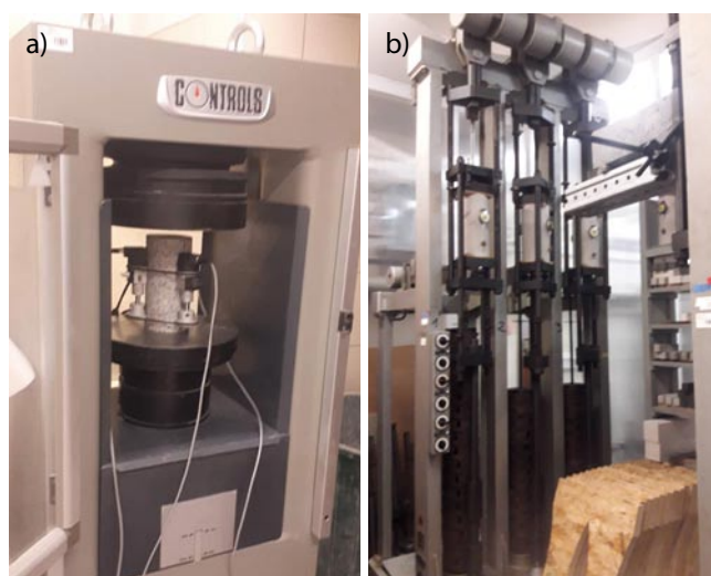
Rys. 3. Urządzenie zastosowane do badań modułu sprężystości (a) i pełzarka (b)
