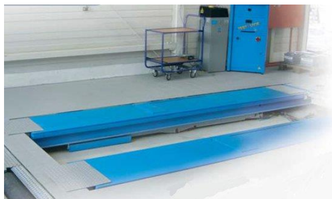
Rys. 2. Miejsce zabudowy podnośnika na stanowisku diagnostycznym badania geometrii kół i osi pojazdu
