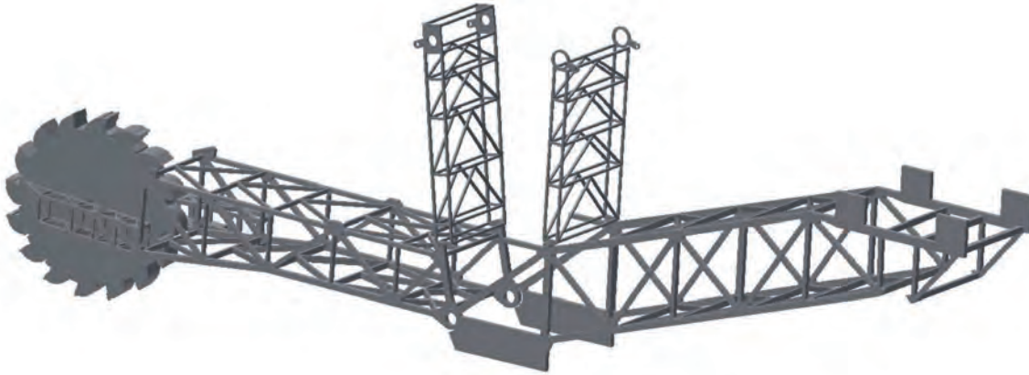
Fig. 1. Geometric model of the bucket wheel excavator's body [1] Rys. 1 Model geometryczny korpusu wielonaczyniowej koparki kołowej [1]
