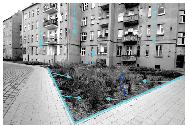
Rys. 13. Schemat działania systemu – ogród deszczowy; źródło: autor
