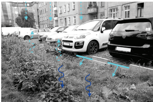
Rys. 9. Schemat działania systemu – parking; źródło: autor
