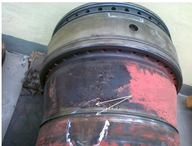
Rys. 1. Erozyjno-korozyjne uszkodzenia powierzchni chłodzonej tulei cylindrowej
