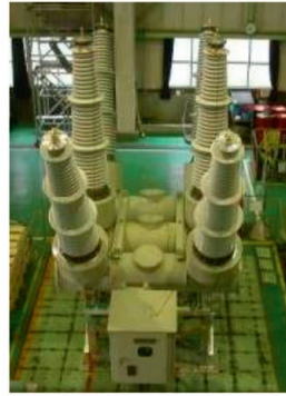
Konstrukcja: dead tank Napięcie znamionowe: 168/204 kV Prąd znamionowy: 2 000 A Prąd zwarciaowy: 40 kA Izolacja dodatkowa: SF 6 Liczba komór próżniowych: 2/fazę Mechanizm: sprężynowo-zasobnikowy
