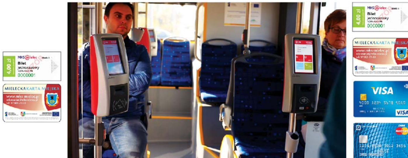
Kasowniki KRG-8 i KRG-12 w autobusie MKS Mielec i koszyk obsługiwanych biletów
