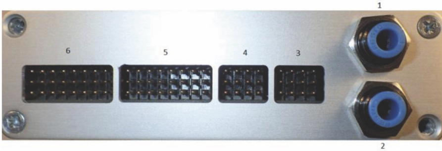
Rys. 3. Panel tylny rejestratora [opracowanie własne Grzegorz Mentrak]. Wejście ciśnienia statycznego (1), Wejście ciśnienia całkowitego (2), Wejścia czujników obrotów (3), Wejścia cyfrowe (4), Wejścia analogowe (5), Wejścia sygnałów RC (6)
