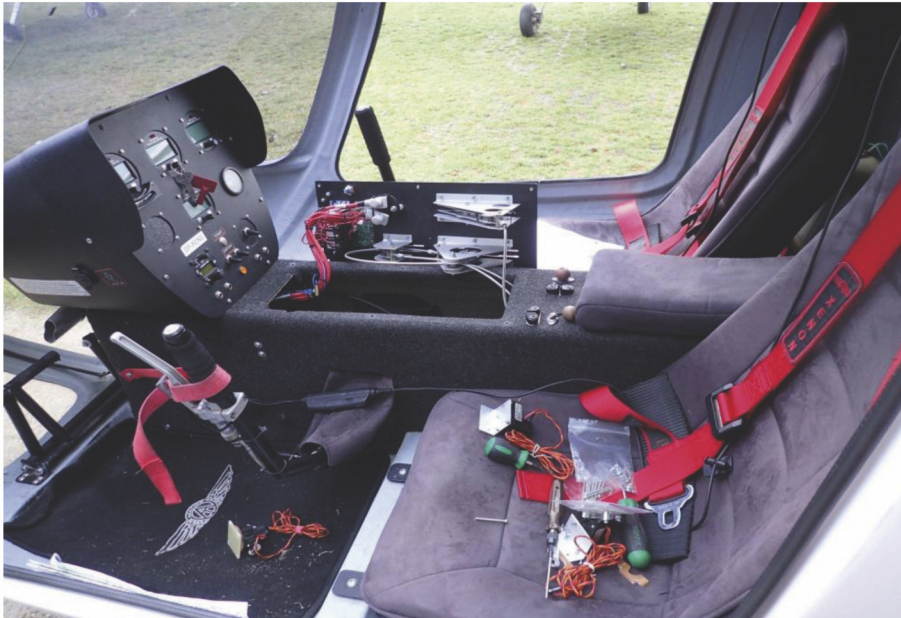
Rys. 4. Otwarty kanał, w którym zamontowano czujniki linkowe [Aut., 2015]
