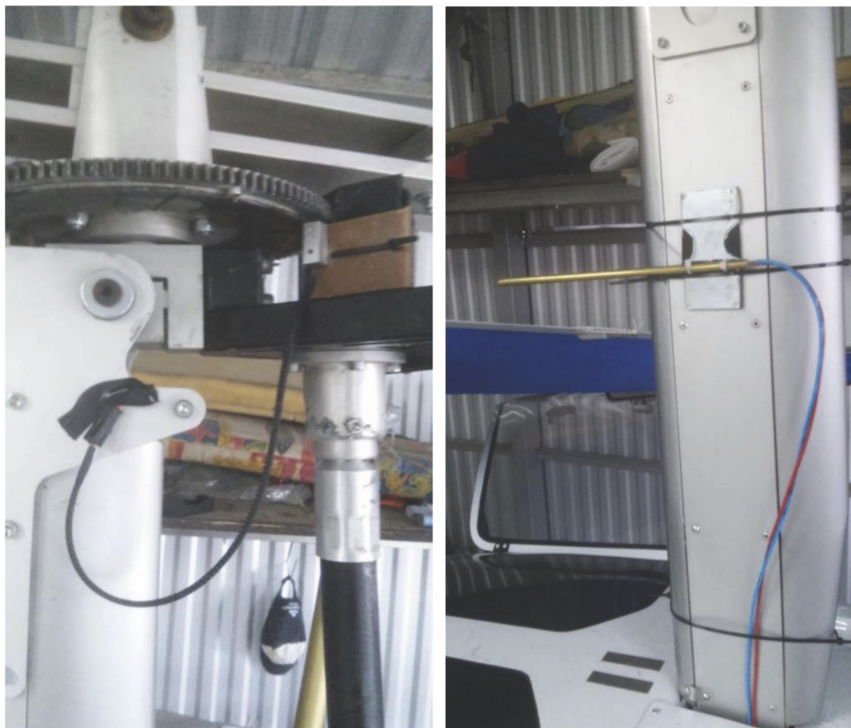
Rys. 5. Czujnik obrotów wirnika i rurka Pitota [Aut., 2015]
