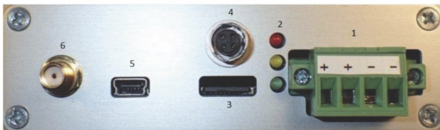
Rys. 2. Panel przedni rejestratora [opracowanie własne Grzegorz Mentrak]. Złącze zasilania (1), Diody sygnalizujące (2), Gniazdo karty micro SD (3), Złącze portu szeregowego (4), Złącze USB (5), Złącze anteny GPS (6)
