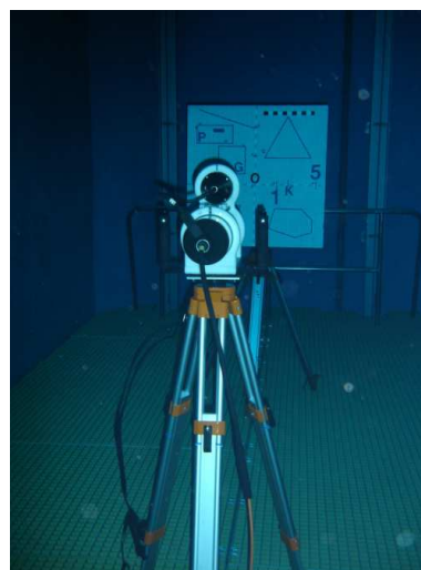
Rys. 4. Operator powierzchniowej części kamery (A) – podest z częścią podwodną jeszcze na powierzchni – i stanowisko pomiarowe w położeniu roboczym na głębokości 5 metrów przed rozpoczęciem pomiarów (B).
