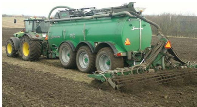
Fot. 1. Doglebowa aplikacja surowej gnojowicy z wykorzystaniem zestawu: zbiornik na gnojowicę, glebogryzarka oraz dysze do podpowierzchniowego wprowadzania gnojowicy (fot. J. Barwicki – zbiór własny)
