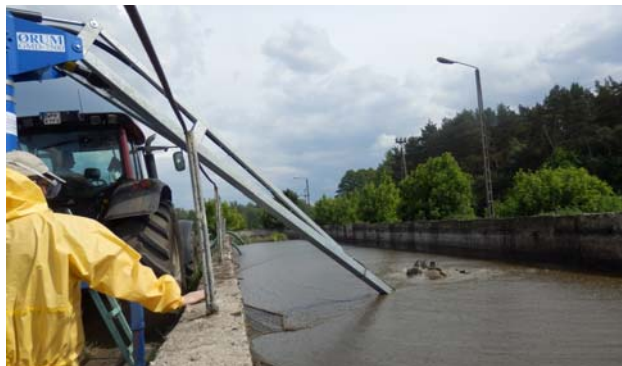
Fot. 3. Zakwaszanie gnojowicy w zbiorniku Zakładu Doświadczalnego w Biebrzy (Instytut Technologiczno-Przyrodniczy) z wykorzystaniem urządzenia duńskiej firmy (fot. J. Barwicki zbiór własny)
