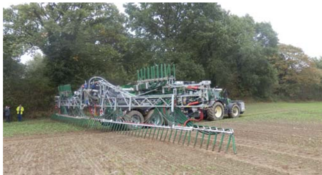
Fot. 2. Wykorzystanie zestawu polowego do rozlewania zakwaszonej gnojowicy wężami wleczonymi na polu (fot. J. Barwicki – zbiór własny)
