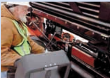
Ryc. 8. Stacja kontroli i zdalnego sterowania systemu pneumatycznego Roughneck R400 [1]
