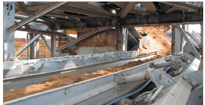
Rys. 1. Przenośnik taśmowy na wysięgniku koła czerpakowego koparki kołowej (archiwum własne autorów)
