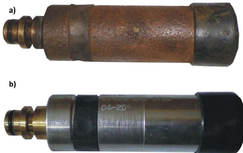
Rys. 5. Wygląd zaworów ograniczających ciśnienie: a – eksploatowany w ścianie 6; b – nowy
