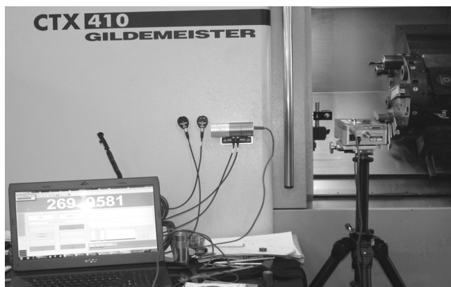
Rys. 2. Stanowisko do pomiaru dokładności pozycjonowania osi Z. Fig. 2. The test stand for measuring the positioning accuracy of Z-axis
