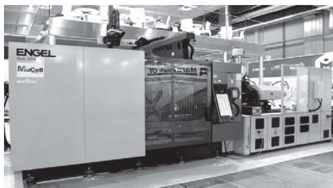
Rys. 2. Wtryskarka ENGEL duo 550
