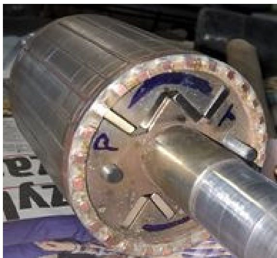
Rys. 3. Widok wirnika silnika w czasie instalowania magnesów trwałych
