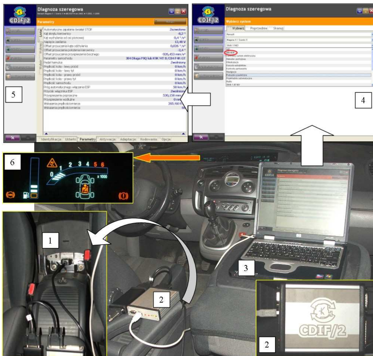
Rys. 1. Sposób podłączenia do gniazda OBD w samochodzie Renault testera diagnostycznego CDiF2. 1- gniazdo OBD, 2-CDiF2, 3-komputer PC z oprogramowaniem, 4-ekran z wyborem systemu diagnozowanego, 5- ekran z dostępnymi do rejestracji parametrami, 6- kontrolki autodiagnostyki od ABS i ESP świecące podczas połączenia z systemem.
