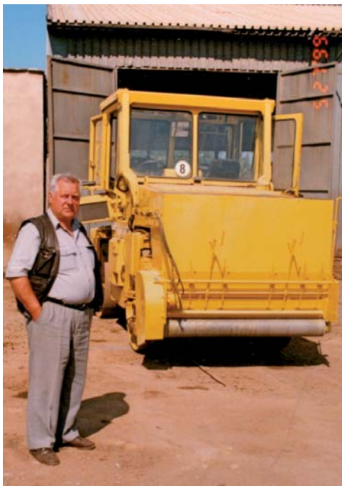
Fot. 5. Stefan Wróbel z jego konstrukcji rozsypuwarką grysów 2/5 mm, zamontowaną na stalowym walcu tandemowym, przed warsztatem na bazie produkcyjnej w Magnuszowicach (fot. Konrad Jabłoński)
