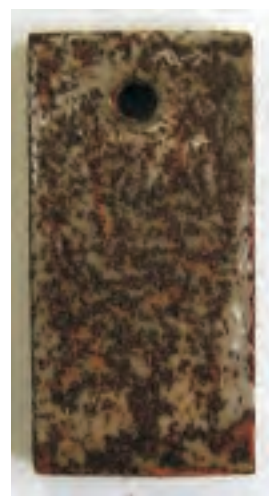
Rys. 3. Kupony ze stali N-80 przed testem wytrawiania w 6% roztworze środka A
