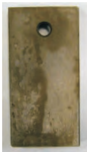
Rys. 8. Kupon ze stali N-80 po 5 h teście korozyjnym w 10% HCl, z dodatkiem 0,1% inhibitora korozji
