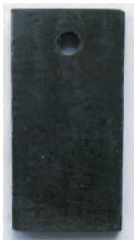
Rys. 7. Kupon ze stali N-80 po 5 h teście korozyjnym w 6% roztworze środka A
