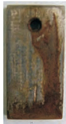
Rys. 2. Kupony ze stali N-80 po teście wytrawiania w 10% HCl
