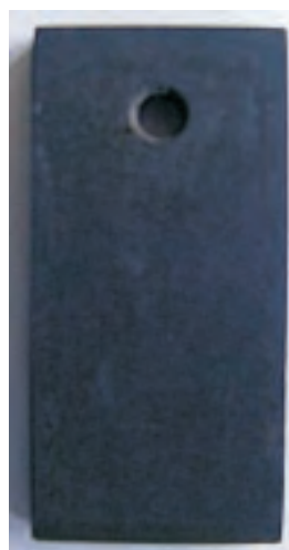
Rys. 4. Kupony ze stali N-80 po teście wytrawiania w 6% roztworze środka A
