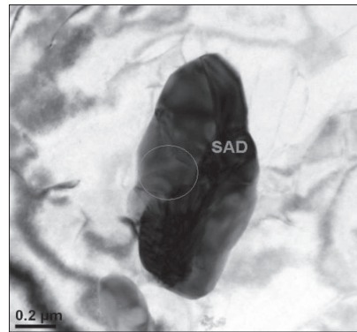
Rys. 9. Wyniki analizy fazowej dla próbki stopu AZ31 – wydzielenie Al_8Mn_5 ; TEM Fig. 9. Phase analysis of the AZ31 alloy sample – precipitate of Al_8Mn_5 ; TEM
