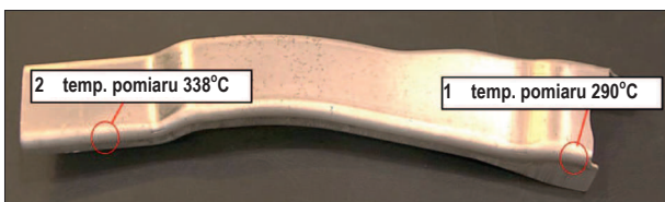
Rys. 6. Wspornik AZ31_300°C_2 mm/s wraz z zaznaczonymi miejscami pobrania próbek do badań struktury, w których zmierzono temperatury 290°C (punkt 1) oraz 338°C (punkt 2)
