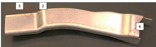
Rys. 5. Wspornik AZ31_250°C_300°C_2 mm/s wraz z zaznaczonymi miejscami pobrania próbek do badań struktury Fig. 5. Bracket AZ31_250°C_300°C_2 mm/s with marked locations of the samples for structural investigations
