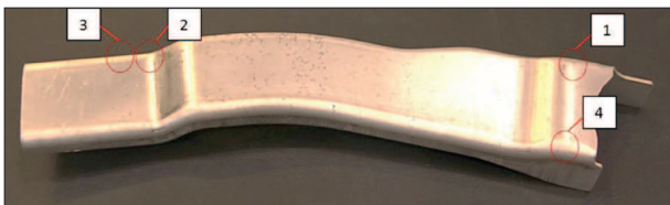
Rys. 4. Wspornik AZ31_150°C_220°C_2 mm/s wraz z zaznaczonymi miejscami pobrania próbek do badań struktury Fig. 4. Bracket AZ31_150°C_220°C_2 mm/s with marked locations of the samples for structural investigations
