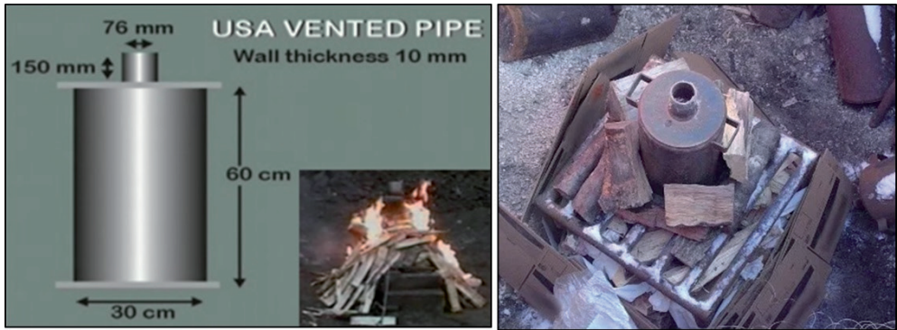
Rys. 3.1.3-a. Naczynie badawcze dla testu poligonowego USA Vented Pipe Test
