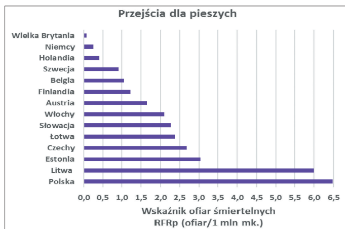
Rys. 2. Rozkład wskaźnika pieszych jako ofiar śmiertelnych RFRp wypadków drogowych na przejściach dla pieszych w Polsce i w wybranych krajach UE w 2016 roku
