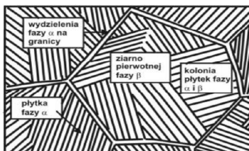
Rys. 1. Schemat kolonii naprzemianlegle ułożonych płytek faz \alpha i \beta w stopach tytanu o dwufazowej budowie [1]
