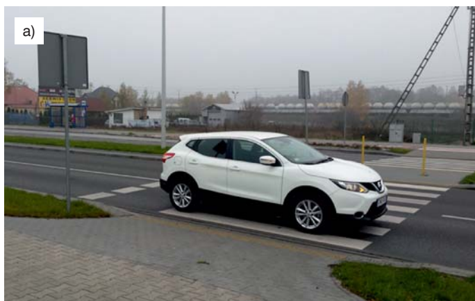
Fot. 5. Różnica w drodze hamowania a) lokalizacja miejsca zatrzymania pojazdu na standardowej nawierzchni, b) miejsce zatrzymanie pojazdu na nawierzchni nopwt (fot. Krzysztof Zalewa)
