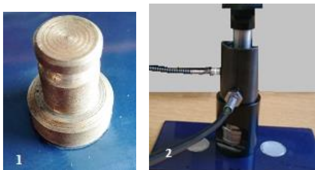
Rys. 2. Stempel pomiarowy (1) oraz uchwyt stosowany do jego odrywania (2)
