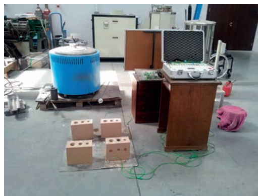
Rys. 2. Ogólny widok stanowiska do badań modyfikacji podeutektycznych stopów aluminium
