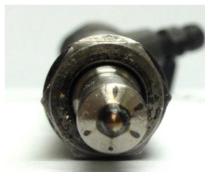
Rys. 3. Widok wtryskiwacza elektromagnetycznego wykorzystanego w badaniach [2]
