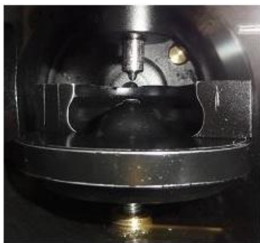
Rys. 1. Widok zmodyfikowanego tłoka z wycięciem części jego korony [2]
