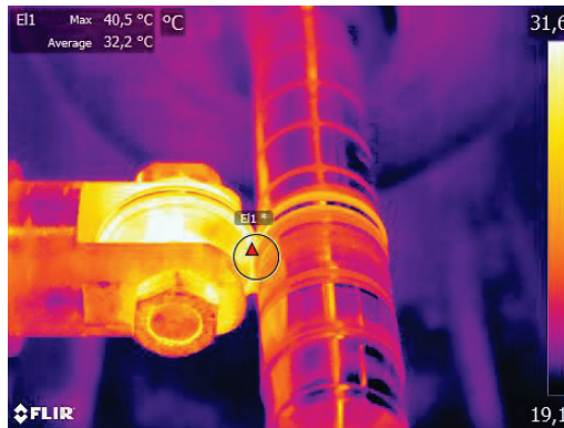
Rys. 5. Powierzchnia pomiarowa temperatury na styku narzędzie–przedmiot
